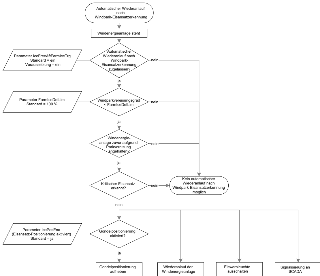
Abb. 4: Automatischer Wiederanlauf nach Windpark-Eisansatzerkennung
