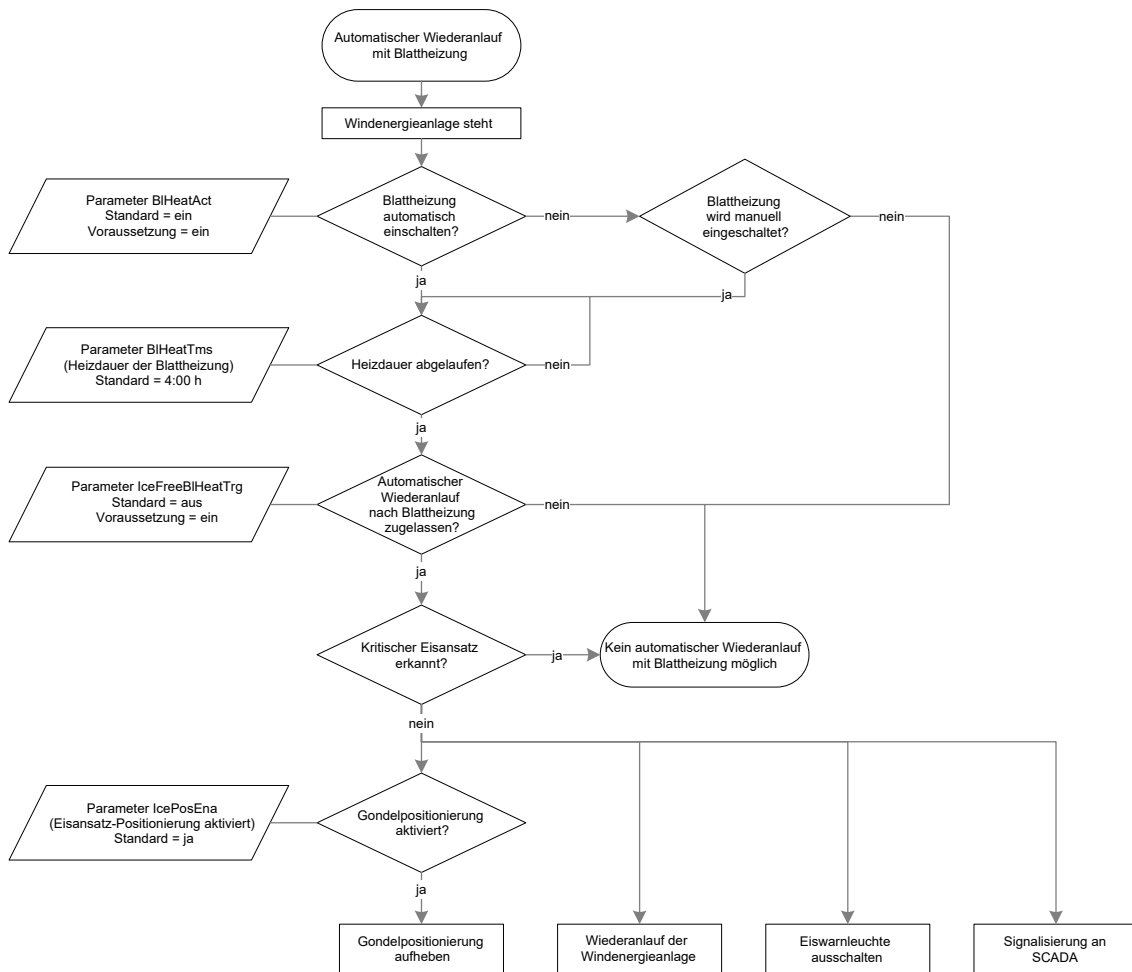
Abb. 3: Automatischer Wiederanlauf mit Blattheizung
